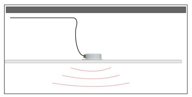
Пример монтажа SMS-VibX на потолок из гипсокартона.
